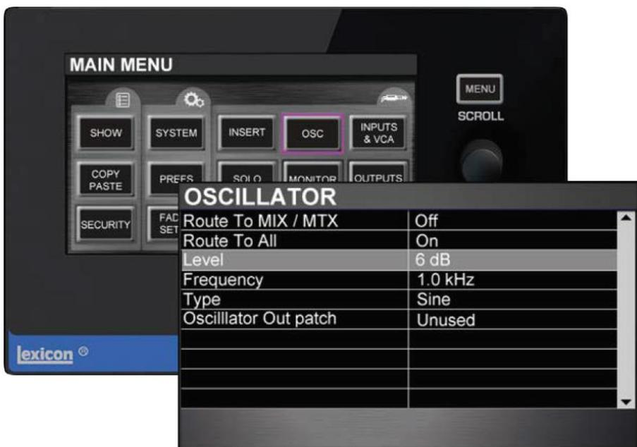
オシレーターの信号を LR と MONO バスに直接ルートすることはできませんが、Mix バスにはルートできます。オシレーターのパッチングはスナップショットに保存できます。コンソールの電源を消すとオシレーターの設定は OFF になります。
