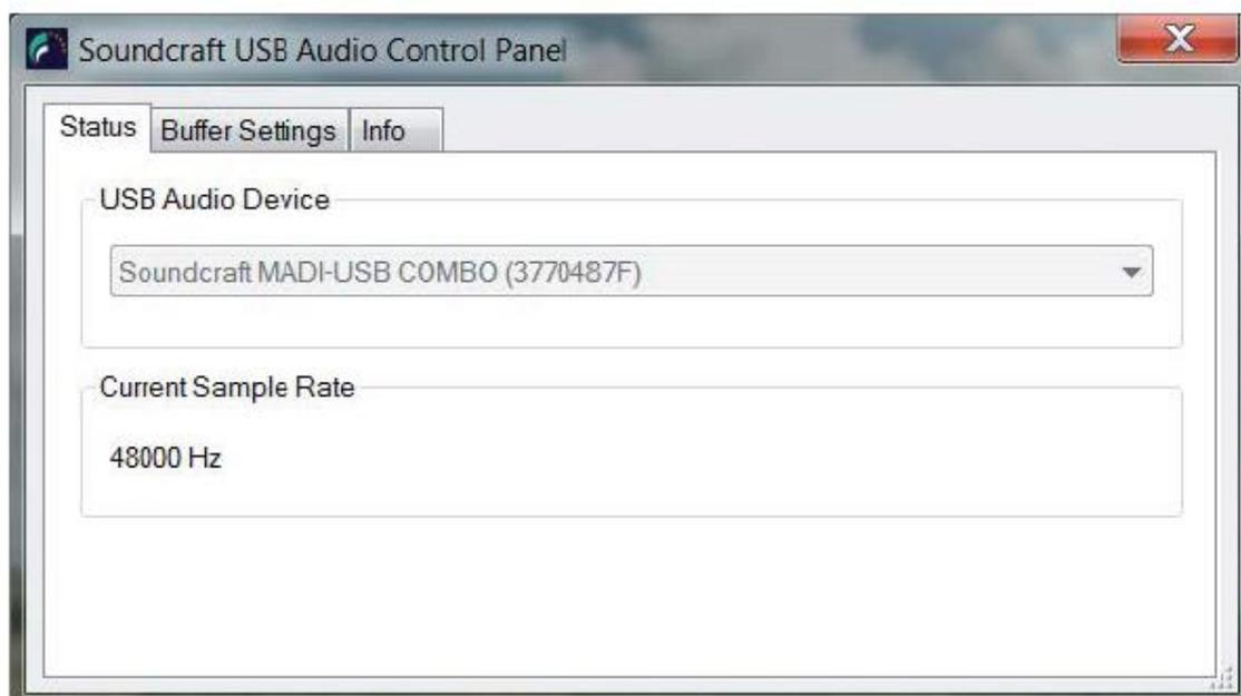
PC ドライバーをインストールする前に、MADI-USB カードをコンソールに取り付けて、PC と MADI-USB カードを接続し、コンソールを立ち上げ直してください。ドライバーがインストールされると、Control Panel のショートカットが使用可能になります。ドライバーを有効にするには PC を再起動する必要があります。
