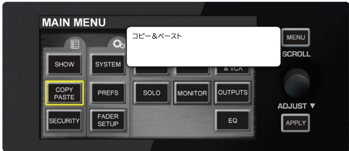
「COPY PASTE」ボタンを押してコピー&ペーストモードを起動します。チャンネル、またはバスを選択したとき、その設定をクリップボードにコピーします。ただし GAIN と 48V 設定はコピーされません。FADER FOLLOW ボタンからバスミックスが選択されているときは、バスミックスがコピーされます。
