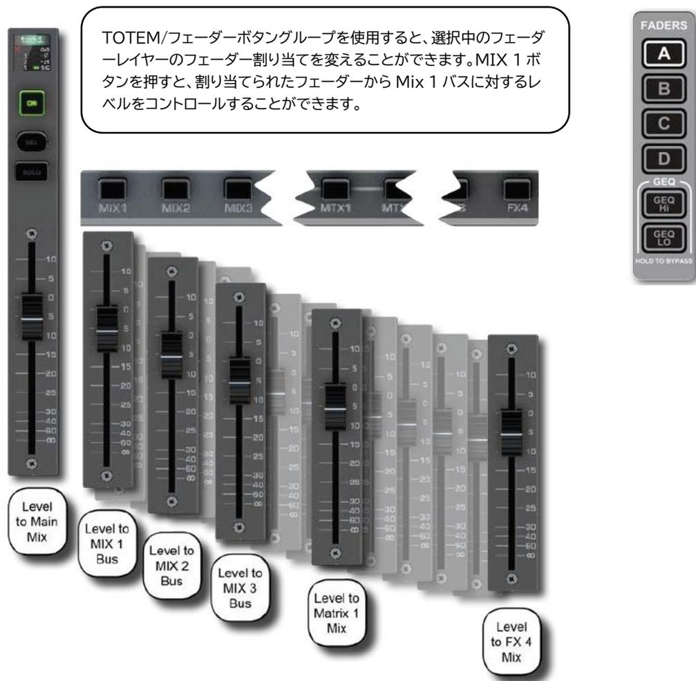
現在のフェーダーレイヤーが「A」(全入力チャンネル)の場合、MIX 1 TOTEM ボタンを押すと Mix 1 に割り当てたチャンネルを入力として、Mono チャンネルを Mix1 マスター出力として割り当てます。
