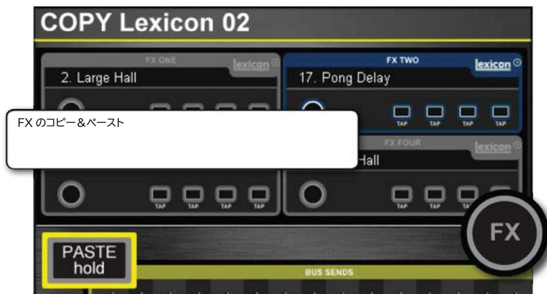
Lexicon プロセッサ間で設定をコピー&ペーストするには、COPY PASTE ボタンを押してから「FX」ボタンにタッチします。
