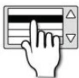
有効のとき、どれか **SOLO** ボタンを押すと他の有効な **SOLO** チャンネルが全てキャンセルされます。
