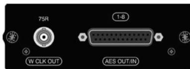
AES D-Type (8ch in、8ch out、D-SUB25 ピン)
