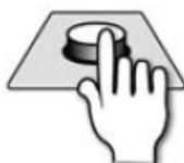
チャンネルを VCA マスターによりミュートすると、ON ボタンが赤く点灯します。ミュートされていないときは緑色になります。チャンネルが選択されていないときは消灯します
