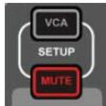
ミュートグループ設定を確認するには、ボタンを長押しします。Channel Name 画面に、ミュートグループのメンバーになっているチャンネルの番号が表示されます。
