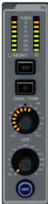
入力セクションはファンタム電源、Mic/Line レベルなど入力チャンネルに関係した項目をコントロールします。メーターは全てのチャンネルにあります。HPF (ハイパスフィルター) はミックスバスチャンネルで調整可能です。
