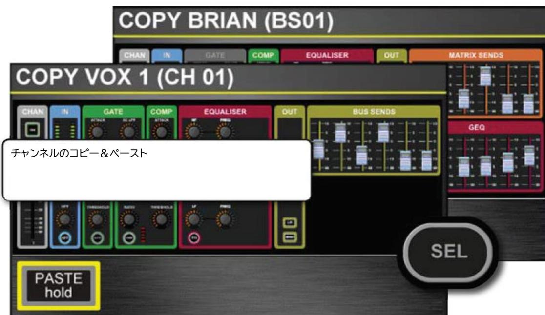
チャンネル（入力チャンネル、またはミックス/マトリクスバス・マスター）を選択し、COPY PASTE ボタンを押すと ACS（バスマスターの GEQ）設定が画面に表示されます。
