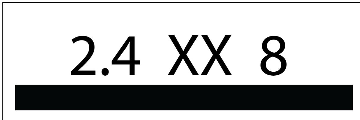
現品表示記号は、以下のことを表しています。この無線機器は 2.4GHz 帯の電波を使用し、変調方式は「その他」の方式、想定与干渉距離は 80m です。2,400MHz～2,483.5MHz の全帯域を使用し、移動体識別装置の帯域を回避することはできません。
