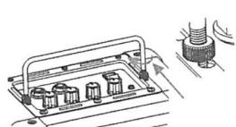
3. 真ん中の部分がパネルに引っかかるようにハンドルをパネル部と平行に押し込み、ロックします。
