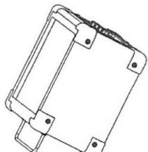
1. ハンドルをアンプ底面の穴に差し込み、モニタースタンドとして使用することが出来ます。
