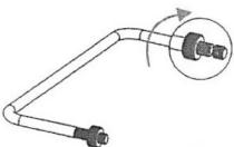
1. ハンドルの先端にあるネジのみぞ部分が見えるまで、スクリューキャップを半時計回りに回します。
