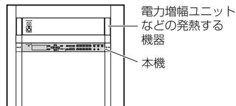
本機をラックに取り付けるときは、付属のラック取付ねじ (M5×12) 2本で、確実に固定します。
