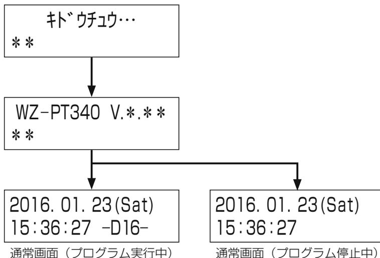
初めて電源投入した場合は本機の時刻設定を促す右の画面が表示されることがあります。この画面は長期に本機の電源をOFFしていた場合（約2週間）に内蔵時計のバックアップ時間が過ぎ、時刻が異常な値になった場合にも表示されます。この画面が表示されたら [決定] ボタンを押し、現在の年月日と正確な時刻を設定してください。
