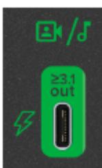
この 2×2 USB-C ポートは MainStream の唯一の電源です。付属ケーブルの一端を本製品の USB-C ポートに、もう一端をコンピューターの USB-C ポートに接続してください。コンピューターの電源が入っていれば、本製品にも電源が供給されます。
