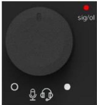
このノブはチャンネル 1 (マイク／ヘッドセット) の音量を、ヘッドフォンおよびミックスマイナスへ送るために調整します。
