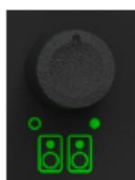
このノブはモニター出力の音量を調整します。∞（オフ、最小：左端）から最大ゲイン（MAX：右端）まで設定できます。ここから出力される信号は、すべての入力のステレオミックスです。ダイレクトモニタースイッチを解除した場合を除き、チャンネル1も含みます。
