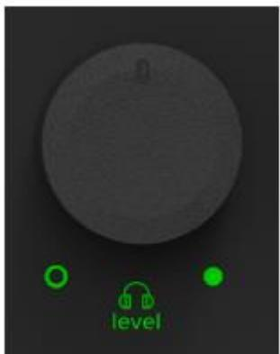
このノブは、1/4インチ・ヘッドフォン出力および1/8インチ・ヘッドセット出力の音量を、∞（オフ）から最大ゲイン（MAX）まで調整します。新しい音源を選択または追加する前に、このノブが完全にオフになっているか必ず確認してください。
