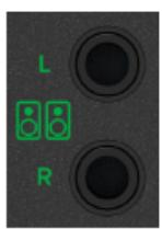
これらの 1/4 インチバランス・ステレオ出力ジャックは、パワードモニターの入力に接続します。出力信号は、すべての入力のステレオミックスです。ダイレクトモニタースイッチをオフにしない限り、チャンネル 1 も含まれます。出力レベルは MainStream 前面のモニター出力レベルつまみで調整します (MainStream 右側にある小さなつまみです。目印として、つまみの下のシルク印刷にモニターのアイコンが表示されます)。
