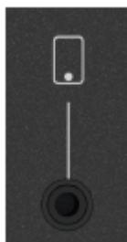
1/8 インチ TRRS コネクターにスマートフォンまたはタブレットを接続します。内蔵ミックスマイナス機能により、遠隔のゲストはエコーヤループバックなしでリアルタイムにやり取りできます。
