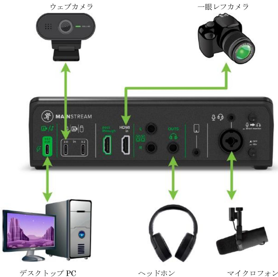
Mackie MainStream を中心に、プロ品質のライブ配信環境を構築できます。HDMI で接続するハイエンド一眼レフカメラ、別アングル用の USB ウェブカメラに加え、高品質な XLR 放送用マイクとヘッドフォンに対応します。すべてを USB-C ケーブル 1 本で PC につなげます。
