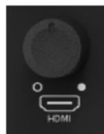
このノブは、HDMI オーディオの入力音量をヘッドフォン、モニター、ミックスマイナス出力へ送るために調整します。
