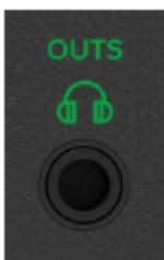
この 1/4 インチ TRS フォン端子は、ステレオヘッドホン（またはヘッドホンアンプ）へ出力します。音量はトップパネルのヘッドフォンつまみで調整します。ヘッドフォン出力の規格は次のとおりです。
