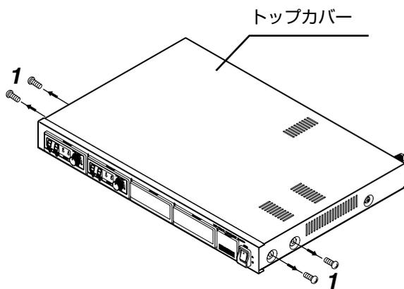
**2** ラックマウント金具に添付のネジ (M4 × 10mm) 4 本で金具ごとトップカバーを共締めして固定します。
