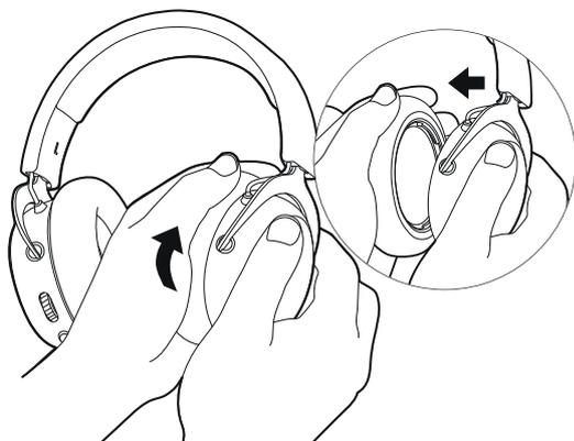
イヤークッションを反時計回りに軽く回し、引き抜きます
