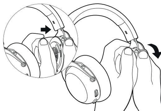
オレンジ色のハウジングにセットし、時計回りにゆっくりと回し、しっかりと固定します
