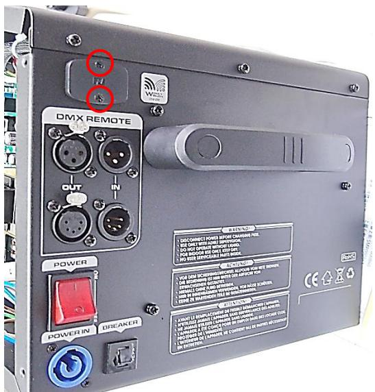
**Schritt 3. Entfernen Sie die Abdeckung.**
