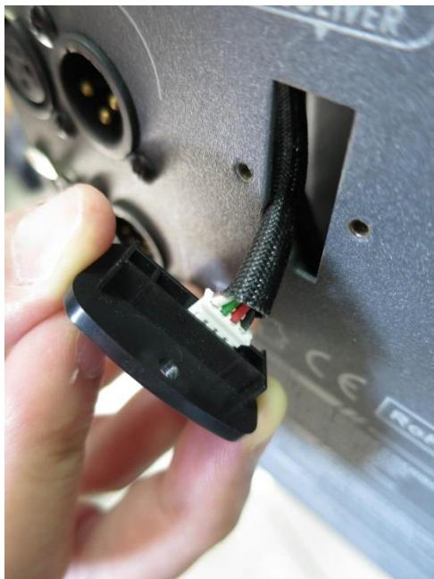
Etape 3 : Connectez les bornes avec le récepteur W-1.
