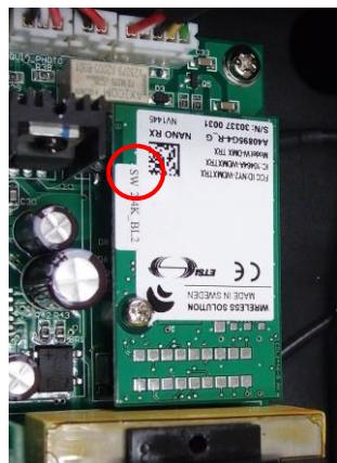
步驟 7. 將 W-DMX 板安裝至主 PCB 上後鎖緊，即完成 W-DMX 天線與主板的安裝。
