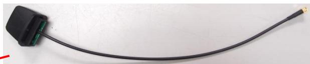
**Etape 4 : Fixez l'antenne (part # W-DMXR) sur le boîtier.**
