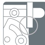
天井設置時に横ぶれしない機構になっているため、垂直方向の角度調整が容易になります
