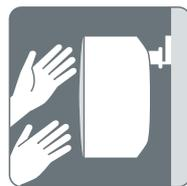
挿し込み型のブラケットなので、結線や角度調整作業が両手を離れた状態できます
