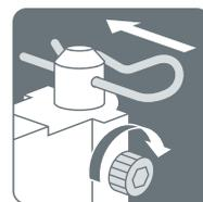
仮ネジ締めとセーフティペンの取り付けは、設置時における万が一のスピーカー落下を防止します
