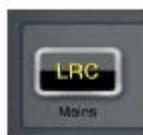
Bus Select ビューで LRC ボタンを押すと、L&R フェーダー (Si Compact、Expression、Performer シリーズ) がホットチャンネルに配置され、標準の INPUTS モードに戻ります。
