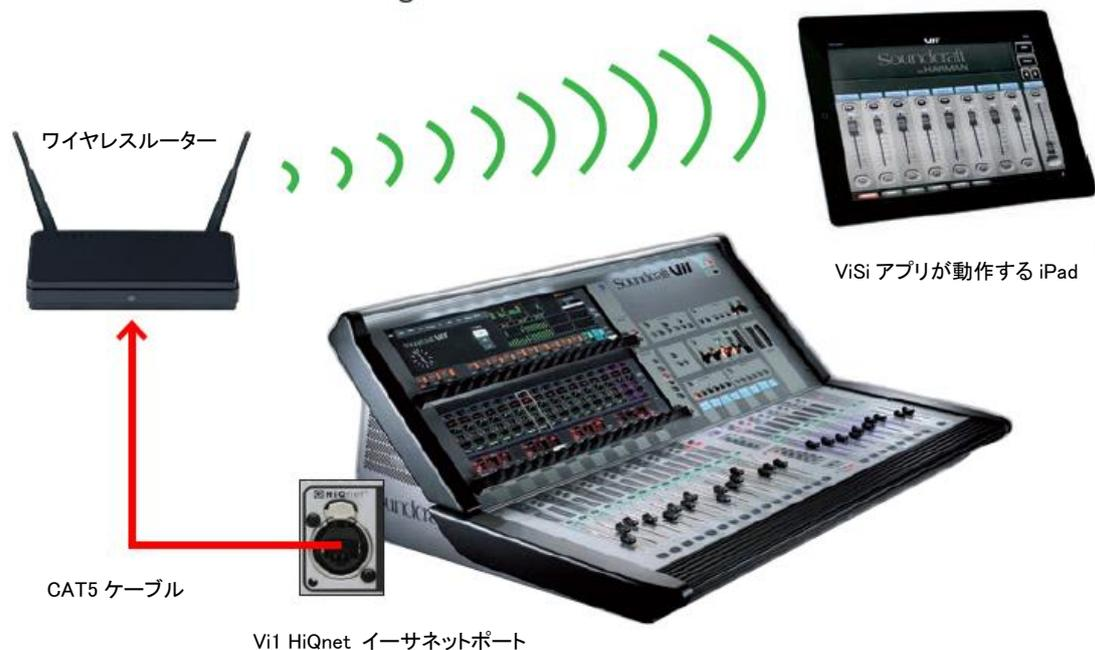
「コンソール/ ViSi Remote」接続には、ルーターを共有する他のデバイスが帯域幅を消費するリスクを避けるため、専用のワイヤレスルーターを使用することをお勧めします。ワイヤレスシステムへの「許可されていない」接続を防ぐため、ルーターのセキュリティを有効にすることをお勧めします。
