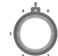
※ 1箇所のチューニング・ボルトを一度に強く締めないでください。ヘッドを均一に張れないため、適切な打感が得られなくなるだけでなく、誤動作や故障の原因にもなります。
