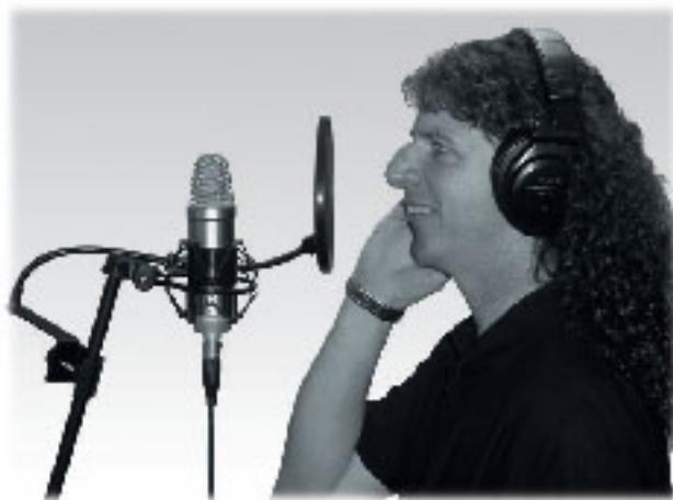
ボーカル録音には必ずポップガードを使用してください。サ行、タ行などの子音や濁点を含む破裂音では空気が激しく噴出される為、カプセルがオーバーロードし、ポップノイズを引き起こします。この問題はポップガードによって未然に防げます。またカプセルに水分が付着することも防止できます。マイクおよびポップガードの設置位置も収録環境や音楽ジャンル、ボーカルの声質によって変える必要があります。
