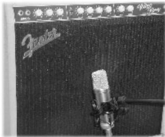
ギター/ベースアンプをコンデンサーマイクで収録するには、アンプのスピーカーにマイクを接近させ、若干傾いた位置にマイクをずらして設置してください（OFF AXIS）。
