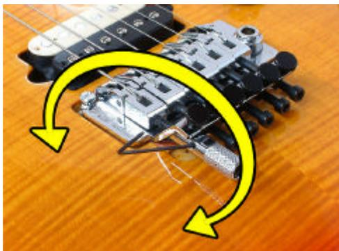
D-TUNER を再度 D ポジションにして、ずれている場合は「D」音に合わせ ~ を繰り返しどちらでも合う状態にします。その後ロックナットを締め、チューニングに誤差がある場合はファインチューナーで調整し再度、それぞれのポジションで「D」音、「E」音とも合っているかを確認します。ずれている場合は をして調整します。
