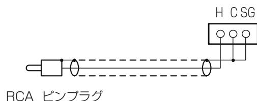
※ ピンプラグからシールド線とSGを接続し、C（コールド）とSG（シグナルグランド）を接続します。
