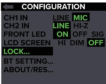
**Locking** - ノブを押すことでこのモードに入ります。ノブを回し、希望の数字が点灯したらノブを押してください。残りの 3 衝の数字についても、同じ手順により設定してください。
