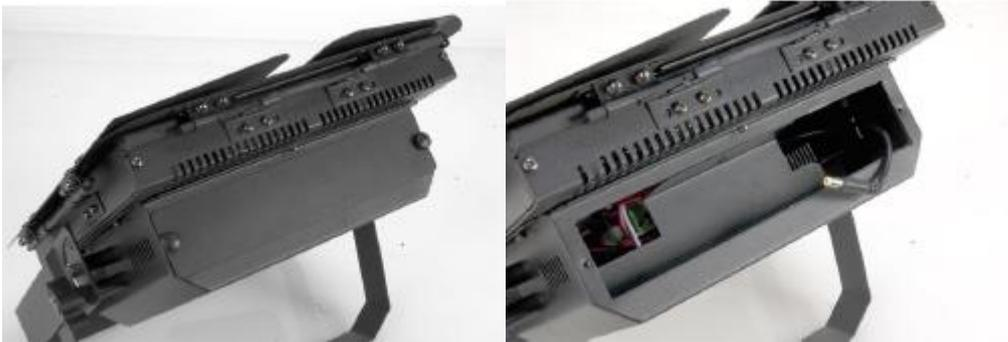
2. カバー内部から電線を引き出し、コネクタをバッテリーに接続します。
