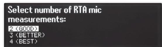
次にオート EQ を実行します。測定用マイクで測定する位置の数を 2 (GOOD)、3 (BETTER)、4 (BEST) から選択し、ホイールつまみを押してください。測定箇所が多くなるほど、分析結果の精度が高まります。
