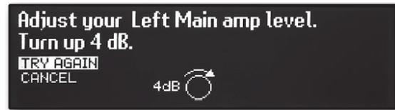
調整の必要がある場合は、図のようなパワーアンプの推奨ゲイン設定が表示されるので、パワーアンプのアッテネーターを調整してください。調整後、TEST AGAIN を選択し、ホイールつまみを押すと、再度測定を開始します。再測定をスキップし、次のスピーカーの測定に進む場合は SKIP を選択し、ホイールつまみを押してください。
