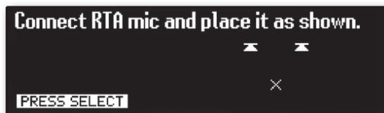
LR スピーカーと正三角形を形成するように、x 印の位置に設置してください。ホイールつまみを押すとメインスピーカーL 側の中域 (left mid) から音圧レベルの測定を開始し、スピーカーのレベルおよび LR のバランスを分析します。キャンセルする場合は、ホイールつまみを押してください。
