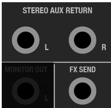
STEREO AUX RETURN は FX SEND から外部エフェクター等に送った信号をミキサーへ戻す入力端子です。通常の入力端子としても使用可能です。
