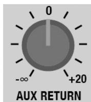
STEREO AUX RETURN に入力された信号レベルを調整します。
