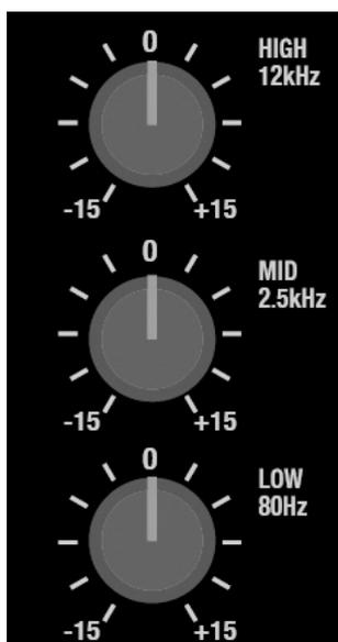
HIGH（高域 12kHz）と LOW（低域 80Hz）はシェルビングフィルターです。MID（中域）はピーク周波数帯（2.5kHz）を調整します。
