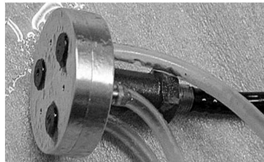
⑦ノズルは 6 角穴付きボルト 2.5mm/3 箇所で固定されていますので、この 6 角穴付きボルトを外して下さい。
