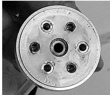
⑨ノズル部の蓋を開けると添付写真のような小さなノズルが出てきます、先端は針先ぐらいの穴があいていますが、ここによく不純物が詰まっているケースが多いようです。ノズル部分の各個所を清掃し、元に戻します。ここにも小さな O-RING を 3 個使用していますので無くさないように、元に戻して下さい。
