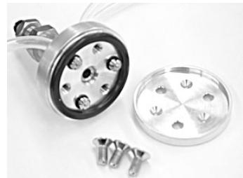
⑧ノズル部を分解すると大きめの O-RING で全体をシールしてありますので、無くさないように保管します。また、この部分の小さな穴にも不純物が詰まっているケースも多い為、針状のものやワイヤーブラシなどで内部を清掃して下さい。
