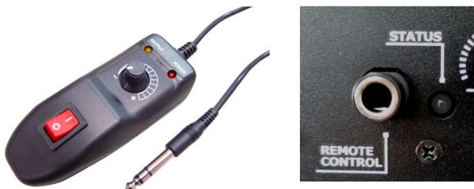
Z-3 有線リモコンのプラグを本製品のリアパネルにある TRS フォン端子に挿し込みます。
