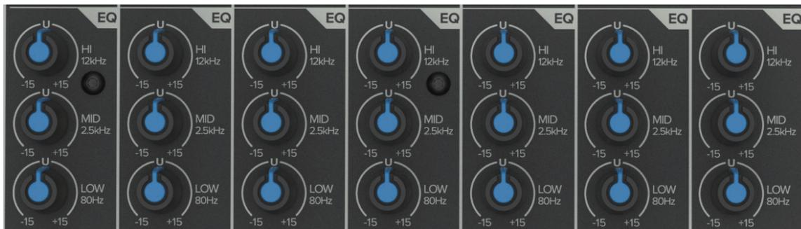
ProFX10 GO ミキサーは、シェルビングハイ、ピークミッド、シェルビングローの3バンドEQを搭載しています。3バンドEQは、ローシェルビング 80 Hz、ミッドピークは 2.5 kHz、ハイシェルビングは 12 kHz に設定されています。
