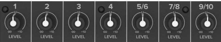
これはチャンネルの信号経路の最後のコントロールで、メインミックスへ出力する各チャンネルのレベルを調整します。「U」マークはユニティゲインを示し、信号レベルが増減しないの意を意味します。曲の一部をブーストする必要がある場合は、最大まで上げると 10 dB が追加されます。レベルがユニティ付近でも音量が小さすぎたり大きすぎたりする場合は、ゲインコントロールが正しく設定されているのを確認してください。
