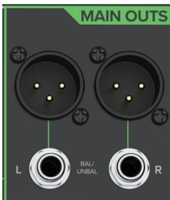
メイン出力は、ラインレベルのステレオ信号が送り出されます。これらを、メインのパワーアンプ、パワードスピーカー、または直列接続のエフェクトプロセッサなどの左右の入力に接続してください。メイン出力は、バランス XLR コネクターに加え、バランスまたはアンバランスの 1/4 インチコネクターも備えています。
