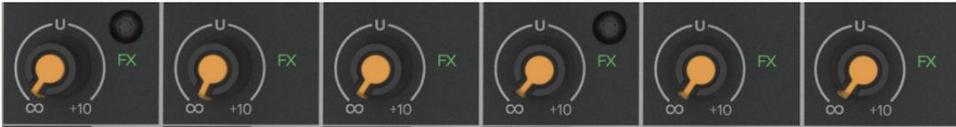
各チャンネルの信号から、内部 FX プロセッサーに送る量を設定したり、FX センドを通じて外部プロセッサーに信号を送信します。
