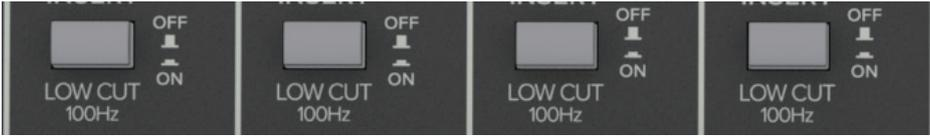
マイク入力のあるすべてのチャンネルには、低域カットスイッチ（ハイパスフィルターとも呼ばれる）が搭載されており、100 Hz 以下の低域を 1 オクターブあたり 18 dB の割合でカットします。
