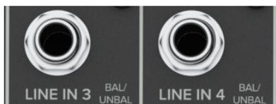
マイクプリアンプと回路(ファンタム電源は除く)を共有しており、あらゆるレベルのバランスまたはアンバランスソースから駆動できます。バランスラインをこれらの出力に接続するには、1/4 インチの TRS プラグを使用してください。
