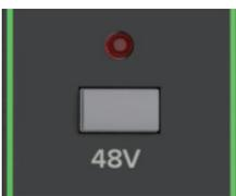
ほとんどの業務用コンデンサーマイクは、48V のファンタム電源を必要とします。この電源により、ミキサーは、オーディオを伝送する同じ配線を通して、低電流の直流電圧をマイクの電子回路に送れます。
