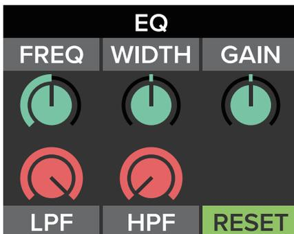
「Reset」がハイライトされたら、コントロールノブを押して、すべての EQ 設定をリセットします。FX EQ をリセットすると、以下のパラメーター値になります。
