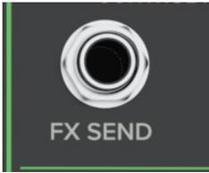
この 1/4 インチ TRS ラインレベル出力は、外部エフェクトプロセッサなどに信号を送るために使用できます。このジャックからの出力は、AUX FX コントロールが最小以上になっているすべてのチャンネルをミックスした、内部 FX プロセッサに入力されている信号と同様です。
