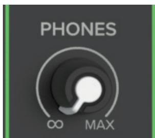
このノブは、∞(オフ)から最大ゲイン(max)まで、ヘッドフォン出力の音量を調整するために使用します。新しいソースを選択・追加する前に、このノブが完全にOFFになっているのを確認してください。
