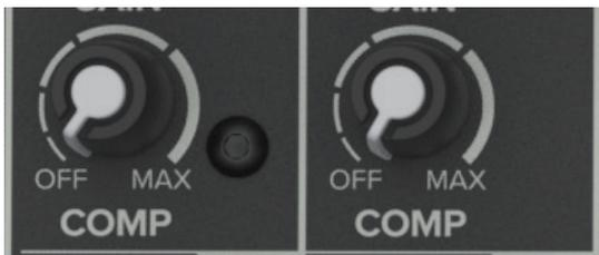
ProFX10 GO ミキサーのチャンネル 1~2 には、可変スレッシュホルドのコンプレッサー回路が搭載されています。
