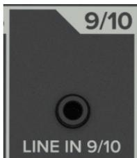
この 1/8 インチステレオ入力は、スマートフォン、タブレット、MP3 プレーヤー、CD プレーヤー、その他の信号源からのステレオまたはモノラルラインレベルの信号を入力できます。
