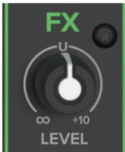
このノブは、メイン出力への内部FXリターンレベルをコントロールします。完全に上げるとFX成分が最大(+10dB)になり、最小にするとドライ(FXなし)になります。FX SENDには影響を与えません。
