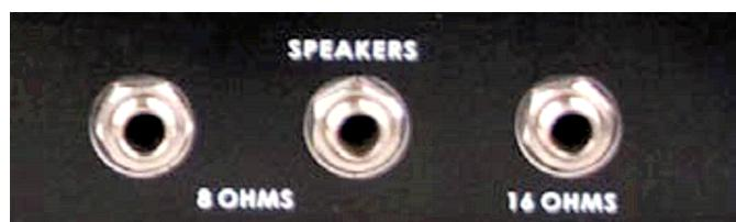
JCA20H は基本的に $16\Omega$ スピーカー用に設計されています。数台のスピーカーキャビネットを接続して使用することもできますが、その際は $8\Omega$ または $16\Omega$ スピーカーキャビネットの使用をお勧めします。
